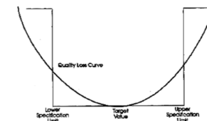
Figuur 2. Kwaliteitsverlies volgens de Quality Loss Function van Taguchi. (Albright en Roth, 1992, p. 22)
